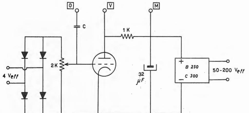
Fig. 58 - Circuito mediante il quale ricavare diagrammi delle funzioni  $I_a = f(V_g)$  (per triodi)
