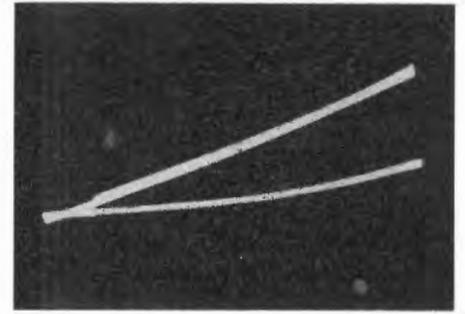
Fig. 55, 55 bis - Caratteristiche di trasferimento relative al triodo di una EC(L)86 (cfr. testo).
