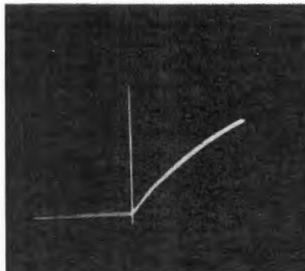
Fig. 62 - Portando la tensione di accensione dai 5 Volt nominalmente richiesti a 6,3 Volt, la stessa 5Y3 GT della figura precedente mostra una netta « ripresa » della emissione elettronica. In entrambi i casi la resistenza in serie all'anodo è di 1 kΩ, la tensione applicata di 50 V<sub>eff</sub>, l'asse Y è stato tracciato per mezzo di un interruttore elettromeccanico. Naturalmente è stato collegato in circuito un solo anodo della 5Y3.
