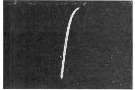
Fig. 27 - Come nella figura precedente, per un solo transistore NPN al germanio (AC127).
