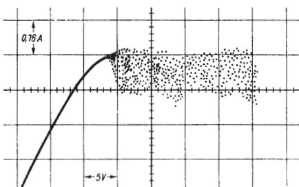
Fig. 1 - Caratteristica corrente-tensione di una prova GaAs. (Secondo una fotografia eseguita all'oscillografo.)
