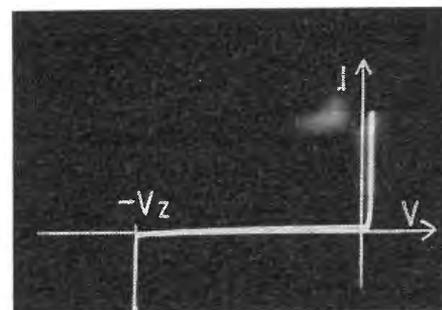
Fig. 34 - Caratteristica di un OAZ212.
