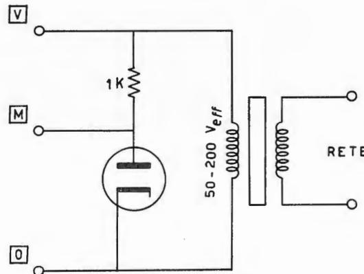
Fig. 60 - Circuito valido per diodi a vuoto. Per i tubi a riscaldamento diretto si conterà un estremo del filamento in O.
