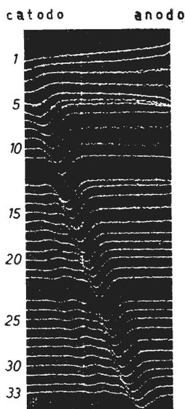
Fig. 4 - Variazione nel tempo del potenziale  $dU/dt$  come funzione della dimensione longitudinale del provino. Lunghezza di prova  $l = 270 \mu\text{m}$ , distanza nel tempo di treni di curve successivi.
