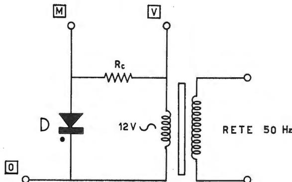
Fig. 31 - Caratteristica di un diodo OA85 al germanio.
