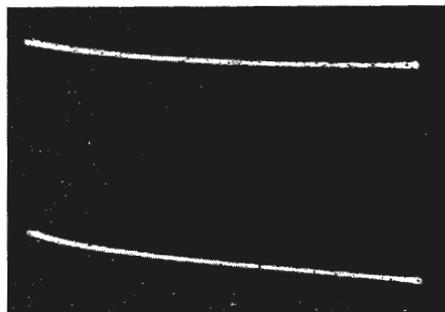
Fig. 24 - Caratteristiche di reazione di un transistor PNP.
