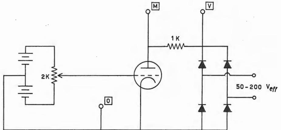
Fig. 53 - Inserzione di un generatore di onde quadre (o a gradini), allo scopo di ottenere più curve del tipo  $I_a = f(V_a)$  contemporaneamente.
