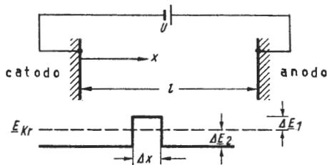
Fig. 5 - Schizzo che illustra il formarsi di una zona locale con resistenza negativa.
