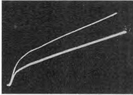
Fig. 54 - Curve ottenute per un triodo di una EC(C)81; l'andamento delle curve non inganni: trattasi delle caratteristiche d'uscita, ma il tubo sta funzionando al di fuori delle condizioni previste dal costruttore; infatti la tensione di griglia è per entrambe le curve positiva ( $+0,5 \text{ V}$  e  $+1,5 \text{ V}$ ).
