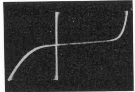
Fig. 51 - Diagramma relativo al parallelo di due diodi, collegati anodo contro catodo (BA 114 e SFD 108). In ascissa: 0,1 V/cm.
