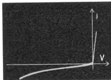
Fig. 33 - Caratteristica di un OAZ208.
