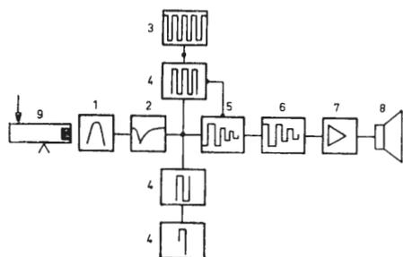
Fig. 8 - Schema a blocchi. - 1. generatore d'impulsi; 2. filtro inviluppo; 3. oscillatore; 4. divisori; 5. modulatore; 6. filtro selettivo d'ampiezza; 7. amplificatore; 8. altoparlante; 9. tasto.
