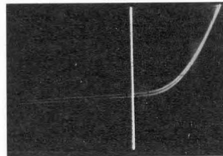
Fig. 40, 41, 42 - Le tre caratteristiche appartengono ad un SFD108, al germanio a punta di tungsteno; per ogni immagine è diversa la « scala » delle tensioni e delle correnti. L'asse  $Y$  è stato tracciato facendo uso di un elementare commutatore elettronico.
