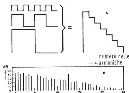
Fig. 12 - La funzione a scalini (A) e il suo spettro di frequenza (B).
