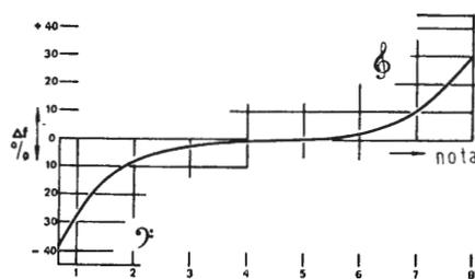
Fig. 6 - Curva di alterazione dell'accordo
